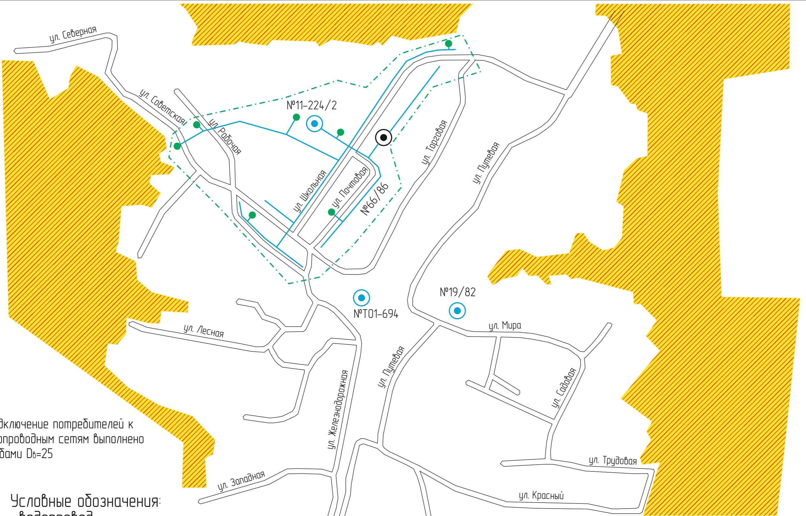
\* подключение потребителей к водопроводным сетям выполнено трубами D<sub>в</sub>=25
